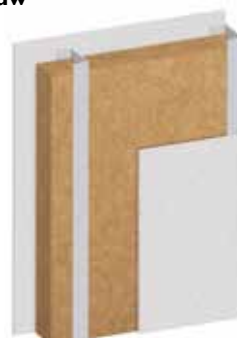
Lichte scheidingswand in metalstudopbouw met GUTEX Thermoflex/GUTEX Thermosafe- homogen
